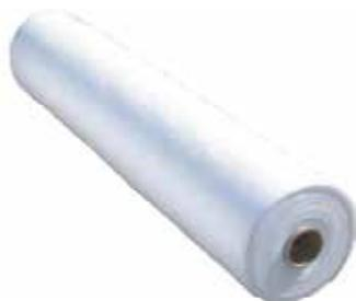
La membrane Aérotex est fabriquée en fibre synthétique. Cette membrane calandree ne pourrit pas et résiste aux acides du sol tout en laissant passer l'oxygène vital au bon fonctionnement de l'élément épurateur. Elle est légère, facile à manipuler et résiste à l'humidité. Elle recouvre la superficie de pierres concassées de l'élément épurateur. Elle peut également être utilisée pour recouvrir la pierre concassée au dessus des drains de fondation.
