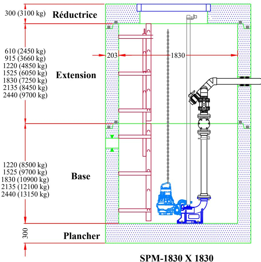
Note: Les masses indiquées correspondent à une épaisseur de mur de 200mm.
