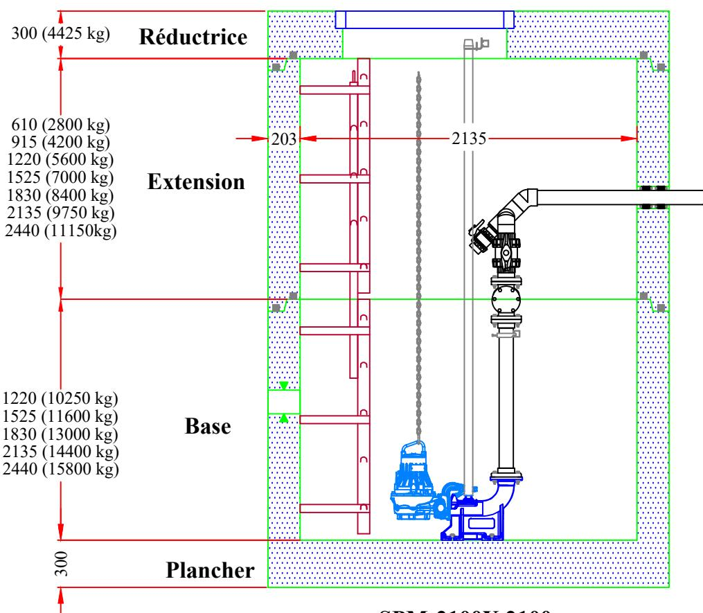
Note: Les masses indiquées correspondent à une épaisseur de mur de 200mm.
