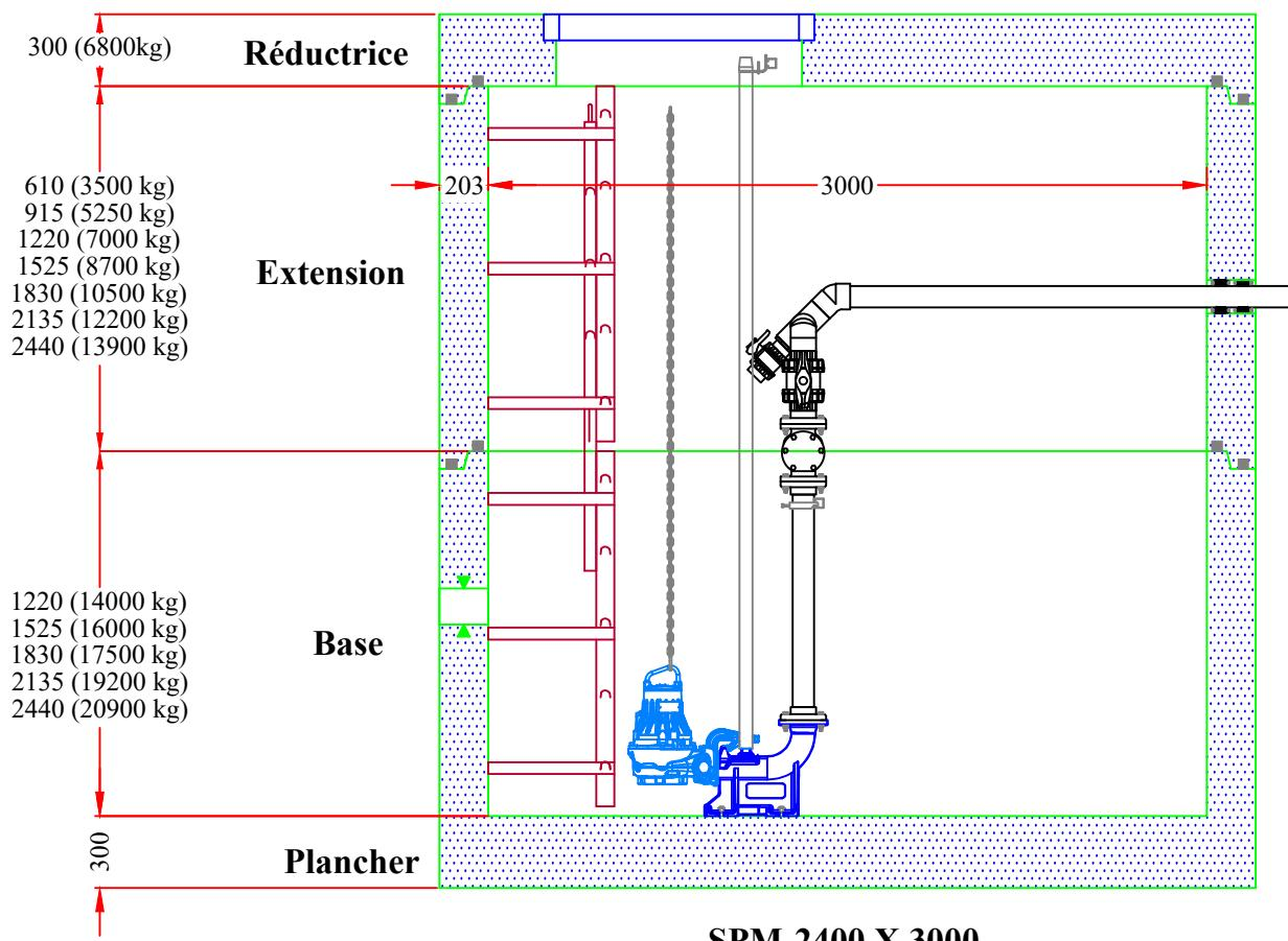
Note: Les masses indiquées correspondent à une épaisseur de mur de 200mm.
